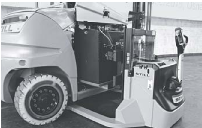
Cambio rápido de batería con la transpaleta ECU 30
