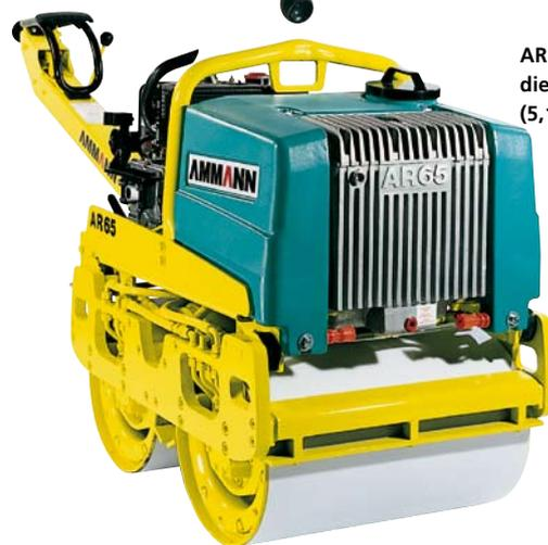
AR 65 con motor diesel Hatz 1D41 (5,1 KW)
