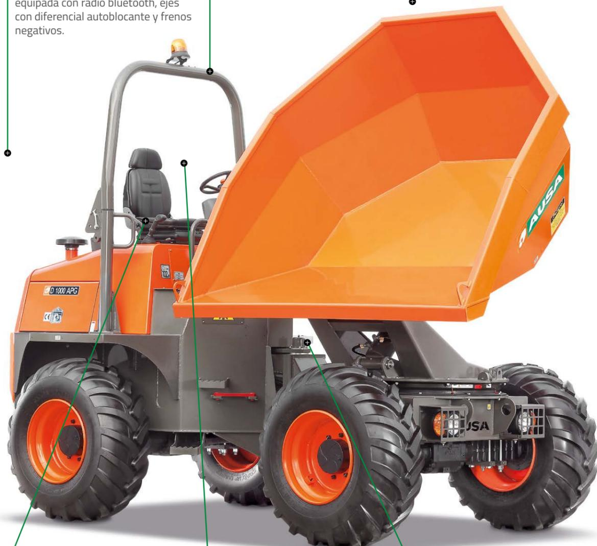
El Joystick All in One Hand en el puesto de conducción ofrece una mayor ergonomía, control total y mayor precisión de movimientos.
