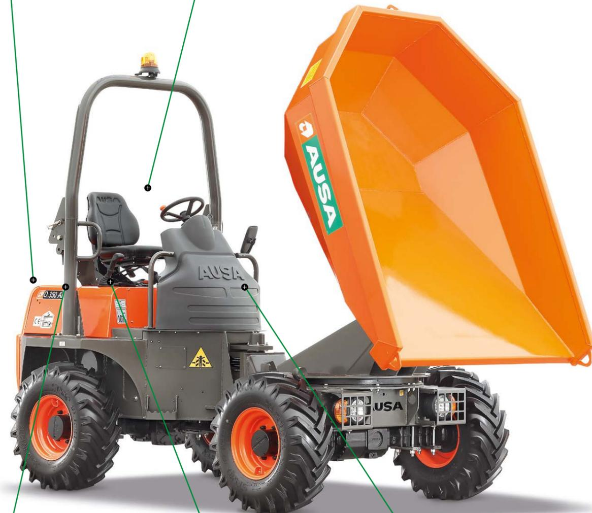
● **Arco ROPS abatible** para facilitar su transporte y asistido mediante amortiguadores de gas para el plegado y desplegado del mismo.
