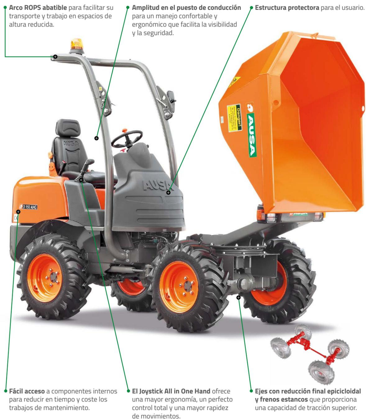
**EQUIPAMIENTO DE SERIE:** Sistema de seguridad antivandálico, asiento ergonómico regulable, cinturón de seguridad enrollable, joystick, arco protector abatible ROPS, faro rotativo, espejo retrovisor y avisador acústico marcha atrás.
