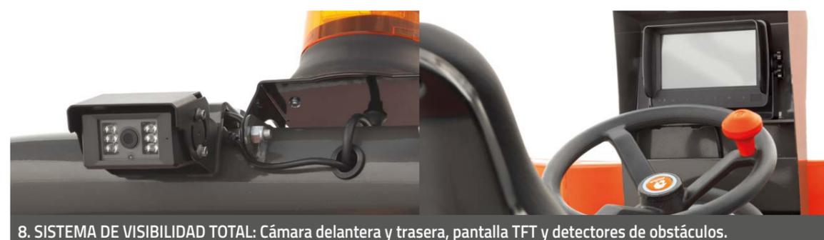
8. SISTEMA DE VISIBILIDAD TOTAL: Cámara delantera y trasera, pantalla TFT y detectores de obstáculos.
