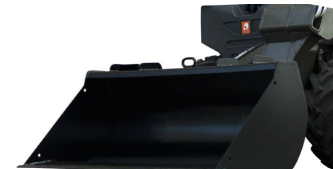
42-44. CUCHARA (CAPACIDAD 330 l; ANCHO 1.440 mm)
