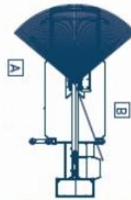
Area con stabilizzatori aperti a sinistra, chiusi a destra Area with outriggers open to the left, close to the right
