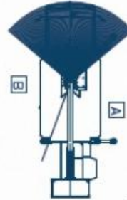
Area con stabilizzatori aperti a destra, chiusi a sinistra Area with outriggers open to the right, close to the left
